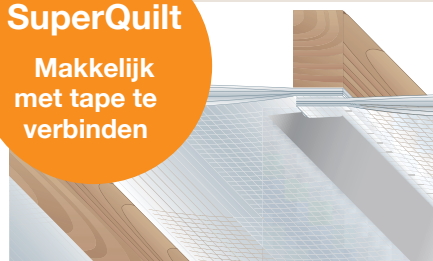
SuperQuilt moet worden aangebracht met een overlap van minimaal 50 mm en daarna worden dichtgeplakt met YBS Foil Tape.
